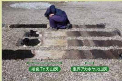
抜き取った地層の表面に樹脂を塗り、布に写し取ったもの。矢印部分が火山灰の層(提供:四国総合研究所)
