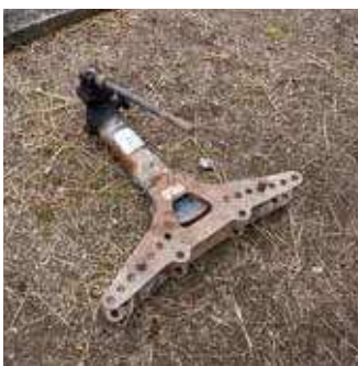
鋼管パイプを曲げるために使われたバンダーとマンモスの骨組み
